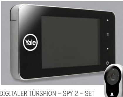
DIGITALER TÜRSPION - SPY 2 - SET Aussenmaß des Türspions 45x70mm Einbau ausführbar in die Türfüllungen 38-110mm stark Größe des Bildschirms 138x76mm - 4,0" Blickwinkel 105°
