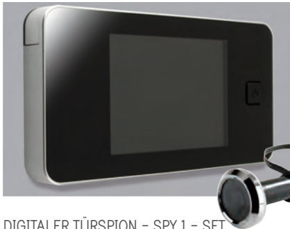
DIGITALER TÜRSPION - SPY 1 - SET Aussenmaß des Türspions \varnothing 32mm Einbau ausführbar in die Türfüllungen 38-110mm stark Größe des Bildschirms 125x68mm - 3,2" Blickwinkel 105°
